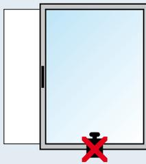
Unterlassen Sie eine zusätzliche Belastung des Schiebeflügels!
