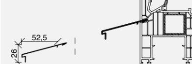
Befestigung über Sägeschnitt im Blendrahmen
