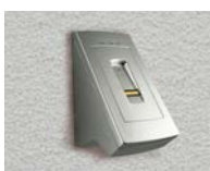
Fingerprint, Scanner und Steuereinheit Aufputz
