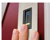
Fingerprint, Scanner und Steuereinheit im Türblatt integriert
